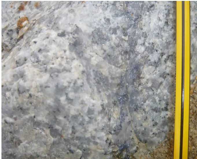
Ảnh 3.2: Molipdenit hạt trung - nhỏ xâm tán trong vi khe nứt của đá granit bị biến đổi sericit hóa, ít muscovit hóa; (NT2303/2) (Ảnh: Nguyễn Văn Niệm, 2017)
