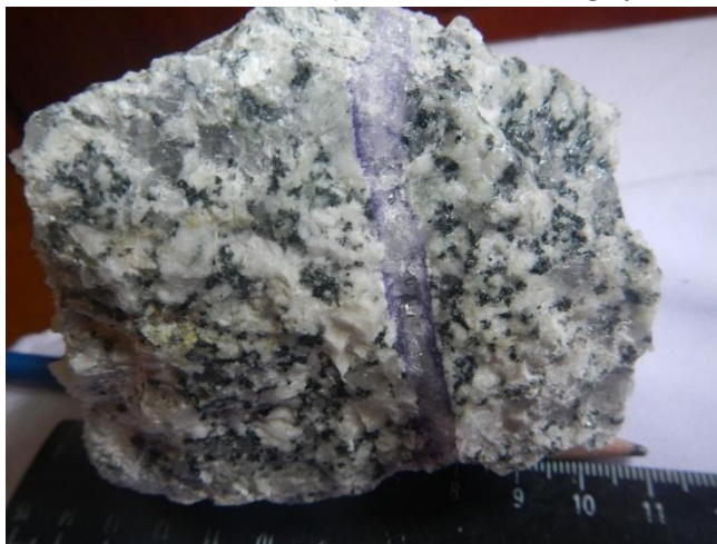
Ảnh 4.6: Mạch thạch anh – fluorit trong đá granit porphyr. Độ cao 650m (NT2302). (Ảnh Vitalii Gvozdev, 2017)
